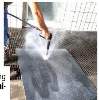
Vor jedem weiteren Einsatz muss gewährleistet sein, dass die „BLACK-CAT“-Tiger-Antirutschmatten schmutz- und staubfrei sind – nur so werden die von den Prüfinstituten DEKRA und Fraunhofer IML zertifizierten Reibbeiwerte eingehalten. **BC-Tiger-Matten niemals in der Sonne lagern!**
