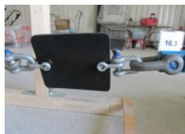
Prüfmuster jeweils im Maß 20 x 24 cm wurden durch Haken und Schäkel eingespannt – der Mittelwert aus drei Versuchen ergab die ermittelte Zerreiβkraft (daN)
